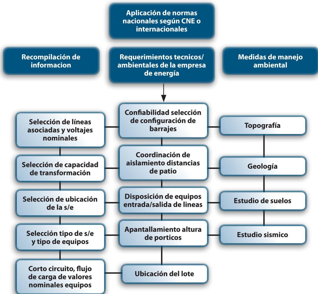
En todo diseño de subestación de proyecto de distribución se tendrá en consideración las características sísmicas de los terrenos sobre los cuales se implementan el proyecto.
